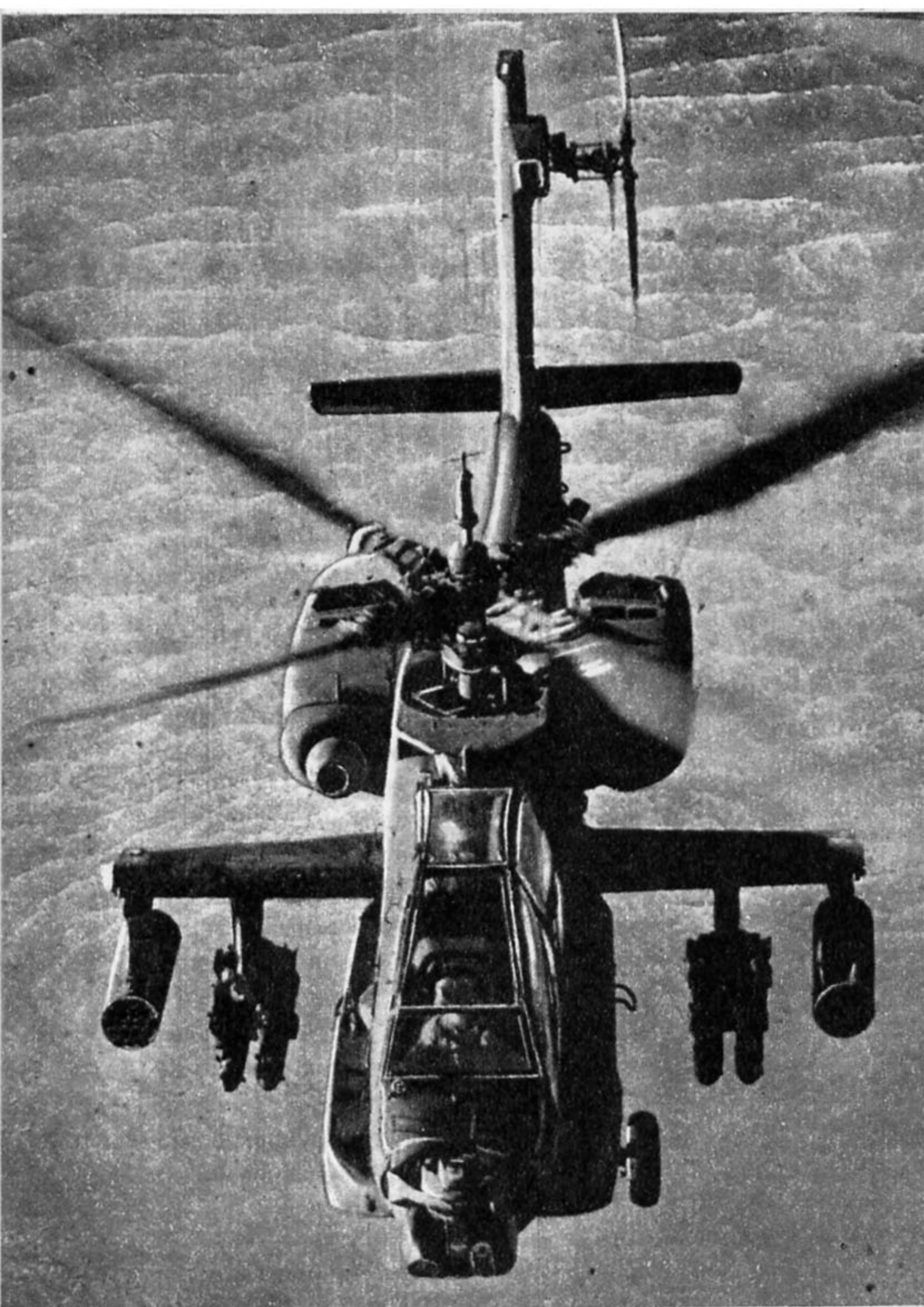
Морской вариант вертолета АН-64А "Апач": 1, 2 — кабина летчика-оператора и летчика; 3 — наддулочная РПС; 4 — несущий винт; 5 — рулевой винт; 6 — стабилизатор; 7 — двигатель; 8 — турели со средствами вооружения; 9 — одноствольная 30-мм пушка; 10 — прицельно-навигационный комплекс.
